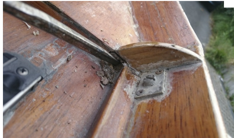
Nicht versteifter Befestigungspunkt der 5. Strebe
