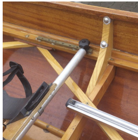
Mit Sperrholzschale, formverleimt E.Frey (1960)
