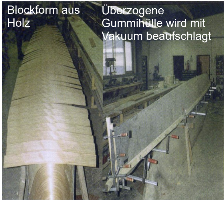
Abb. 23.: formverleimte Bauweise - Blockform und Vakuumpresse
